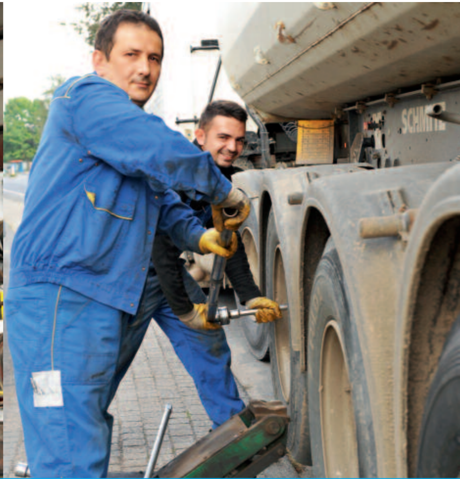
Pannenservice: Montage eines LKW-Reifens vor Ort
