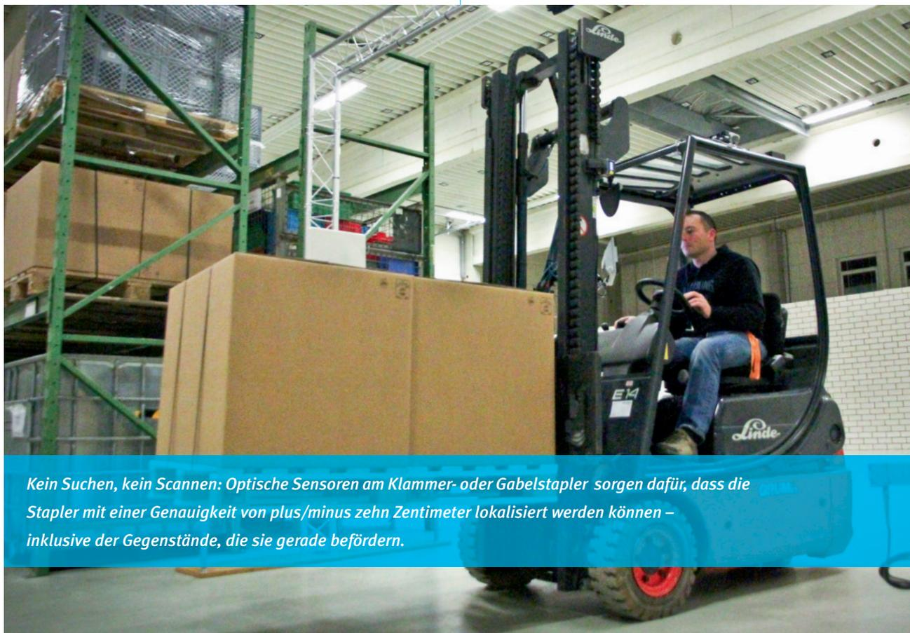
*Kein Suchen, kein Scannen: Optische Sensoren am Klammer- oder Gabelstapler sorgen dafür, dass die Stapler mit einer Genauigkeit von plus/minus zehn Zentimeter lokalisiert werden können – inklusive der Gegenstände, die sie gerade befördern.*
