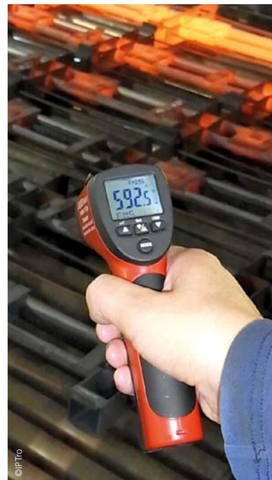
Allein mit der Abwärme aus der Härtung können die Lackieröfen bei Ahle geheizt werden. Gas wird dafür keines mehr benötigt.
