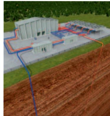
Eine Wärmepumpe verfolgt das umgekehrte Prinzip des Kühlschranks. Die in Erdreich und Luft gespeicherte Sonnenenergie wird dabei zum Heizen und Warmwasserbereiten eingesetzt. Wärmepumpensysteme zur gewerblichen Nutzung müssen einem flexiblen Bedarf an Heiz- und Prozesswärme entsprechen. Eine intensive Beratung hilft bei der Bewertung.
